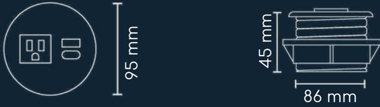
Su montaje requiere de un orificio de 86 mm (3 - 3/8") de diámetro.
