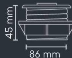
Su montaje requiere de un orificio de 86 mm (3 - 3/8") de diámetro.
