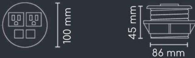
Su montaje requiere de un orificio de 86mm ( 3 - 3/8" ) de diámetro.
