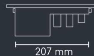
Su montaje requiere de un orificio de 217 x 65 mm.
