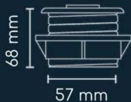
Su montaje requiere de un orificio de 60 mm ( 2 - 3/8" ) de diámetro.
