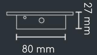
Su montaje requiere de un orificio de 126 x 83 mm.
