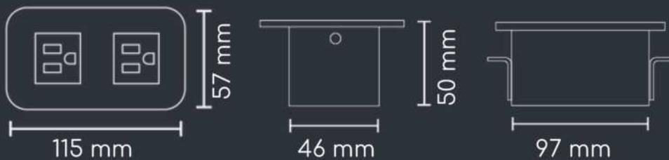
Su montaje requiere de un orificio de 100 x 49 mm.
