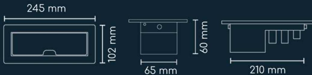
Su montaje requiere de un orificio de 220 x 68 mm.
