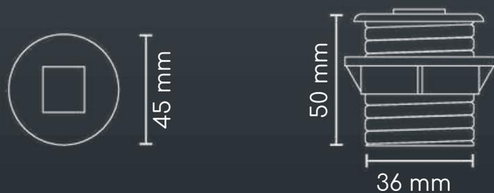
Su montaje requiere de un orificio de 38 mm (1 - 1/2") de diámetro.
