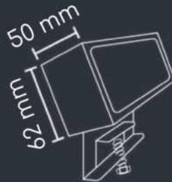
Para sujeción en cubiertas con un espesor máximo de 35mm
