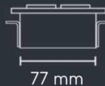
Su montaje requiere de un orificio de 80 x 44 mm.
