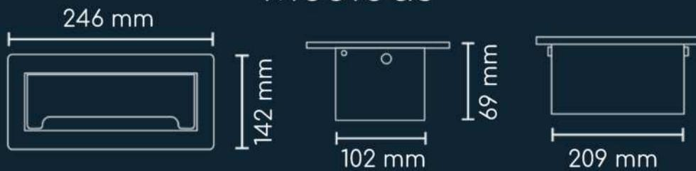
Su montaje requiere de un orificio de 219 x 105 mm.
