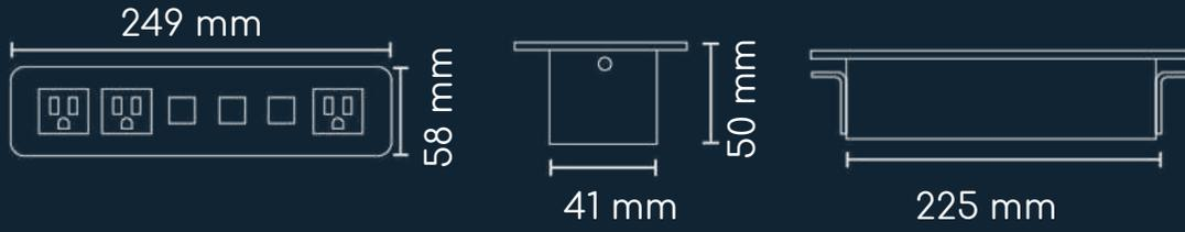
Su montaje requiere de un orificio de 228 x 44 mm.
