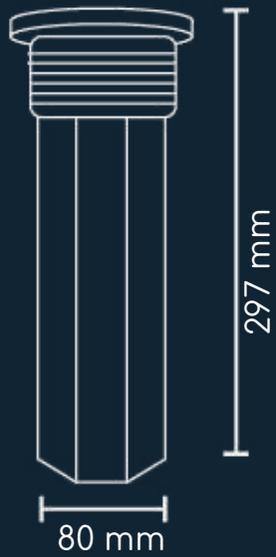
Su montaje requiere de un orificio de 92 mm (3 5/8") de diámetro.
