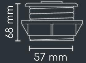
Su montaje requiere de un orificio de 60 mm (2 - 3/8") de diámetro.
