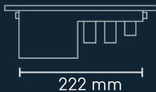
Su montaje requiere de un orificio de 232 x 100 mm.
